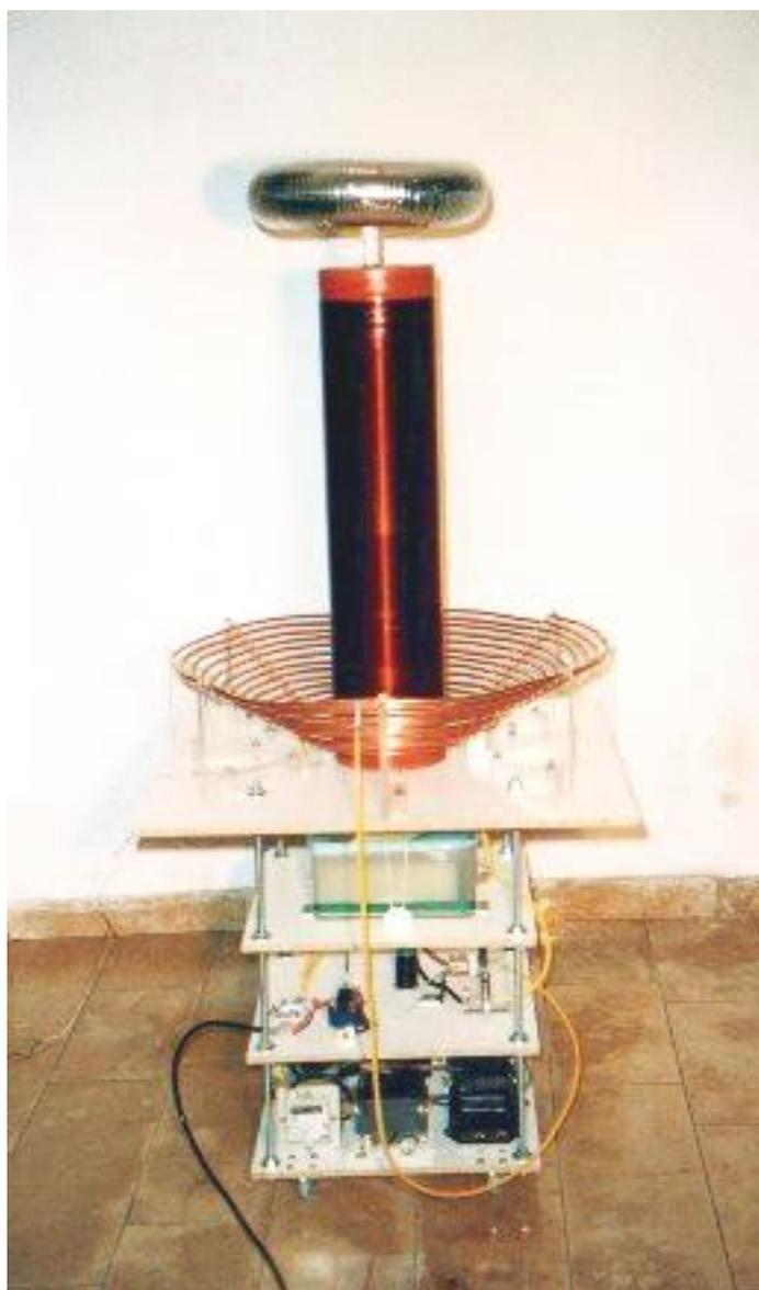
Bild 7: Die fertige Teslaspule kurz vor der Inbetriebnahme
