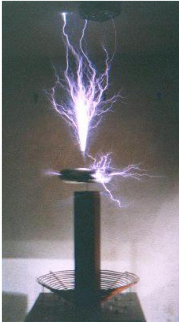
Bild 8: *Spitzenentladungen mit Hilfe eines Drahtstücks*
